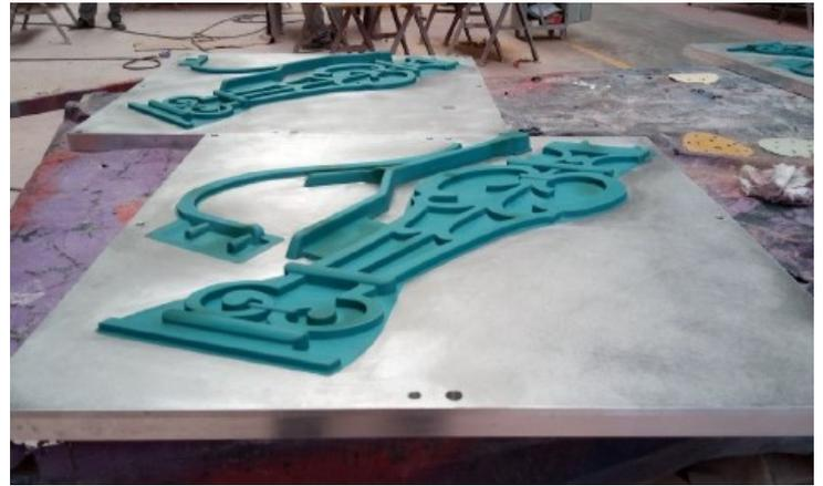
Foto: Modellbau Mattern - Modellplatten für den Guss
