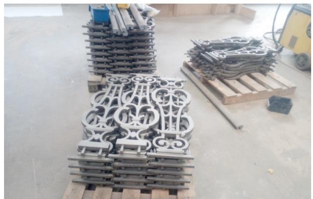
Foto: Modellbau Mattern – Gussteile nach dem Putzen
