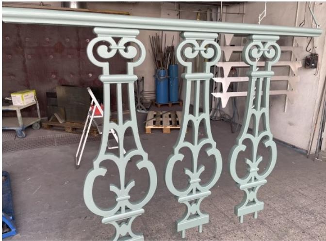
Foto: Modellbau Mattern – Pulverlackierbeschichtung
